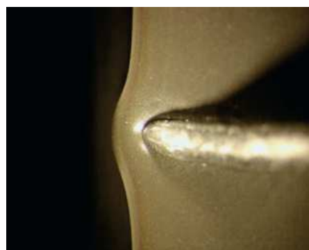
Los labios protectores de una junta de eje tras un ciclo de pruebas con un material FKM estándar (arriba, con formación de roturas) y con material BRE-FKM 75 FKM 260507.
