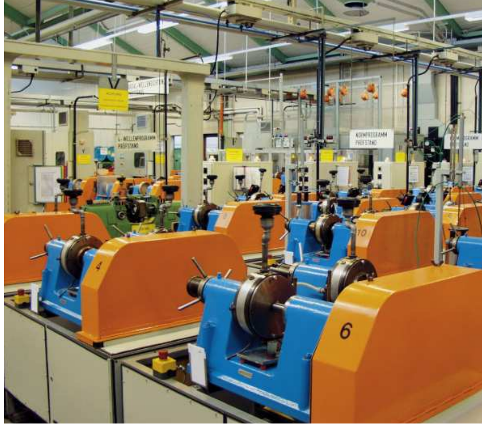
Los lugares de pruebas de juntas de ejes de Simrit son no sólo estándares sino también instalaciones especiales.
