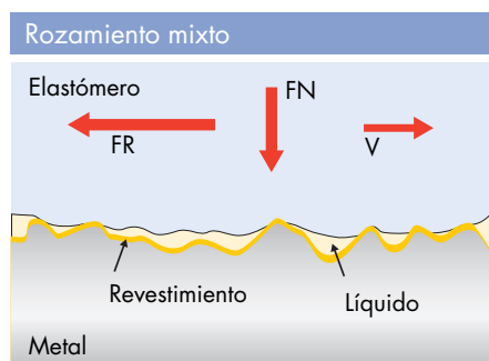
En caso del rozamiento conocido como mixto, las superficies se tocan sólo de forma puntual. Se da, por ejemplo, cuando no hay suficiente lubricante.
